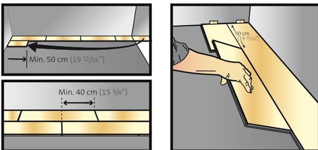
BOEN Parkettdielen mit Click Verbindung benötigen keine Leimangabe an den Profilen. In bestimmten Fällen, z.B. bei einer erforderlichen Rückwärtsverlegung, kann durch das Entfernen der Zunge auf der Nutwanne das Element einfach eingeschoben werden. Auch in diesem Fall ist bei einer vollflächigen Verklebung eine Leimangabe im Profil erforderlich.
